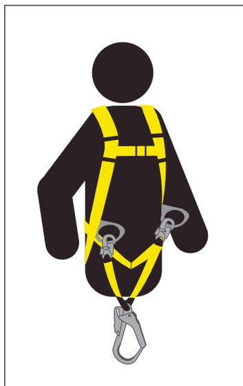
Los ganchos chicos se colocan en las anillas de la cadera del arnés. El gancho grande se asegura a un anclaje permitiendo trabajos de sujeción o posicionamiento.
