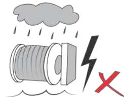
Evite el uso del winche en la lluvia. No moje el interruptor ni el motor.
